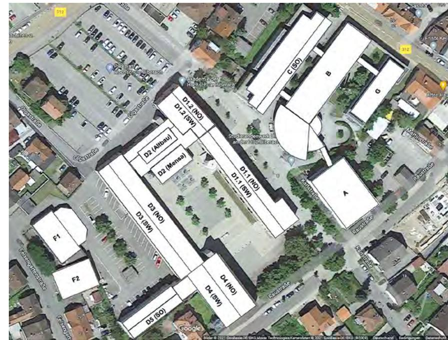
Abb. 83: Lageplan Campus Stadt mit Kennzeichnung der in der Potenzialanalyse berücksichtigten Dachflächen; eigene Darstellung auf Grundlage von [44]
