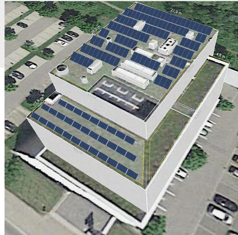
Abb. 105: Gebäudemodellierung und Anlagendesign für das PBT-Gebäude [43]
