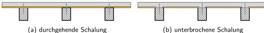
Abbildung 3.1: Prinzipielle Unterschiede in der Ausführung der Schalung
