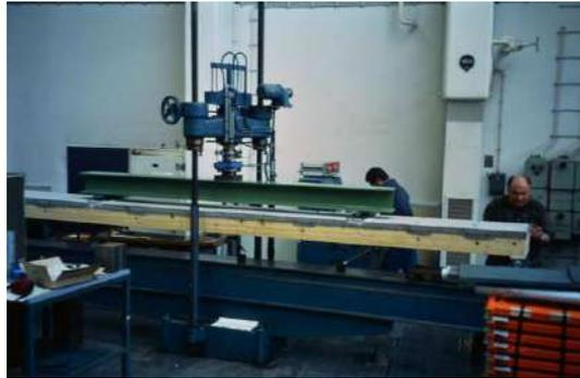
Abbildung 1.1: Holz-Beton-Verbundträger im Versuch (siehe FMPA (1996) und Braun u. a. (1998))
