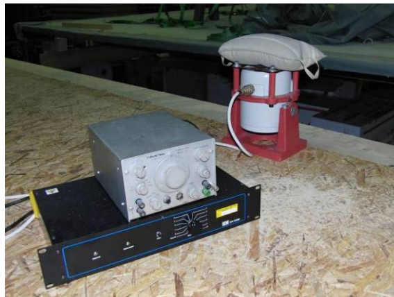
Abbildung 6-5 Anregung durch Shaker
