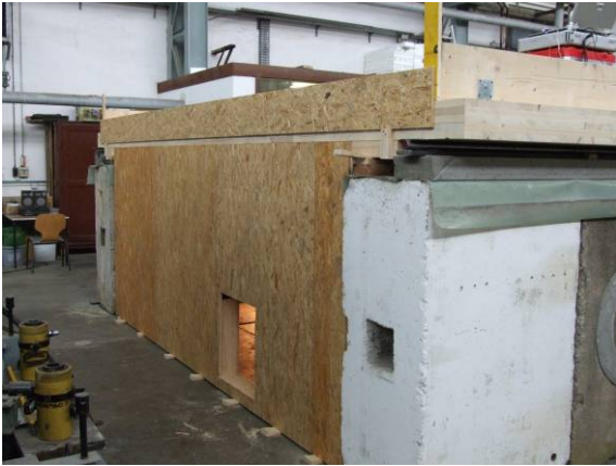
Abbildung 6-17 Großer Deckenversuchsstand, vierseitige Lagerung
