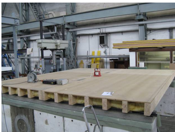
Abbildung 1-2 Großer Deckenversuchsstand in der großen Versuchshalle der MFPA Leipzig
