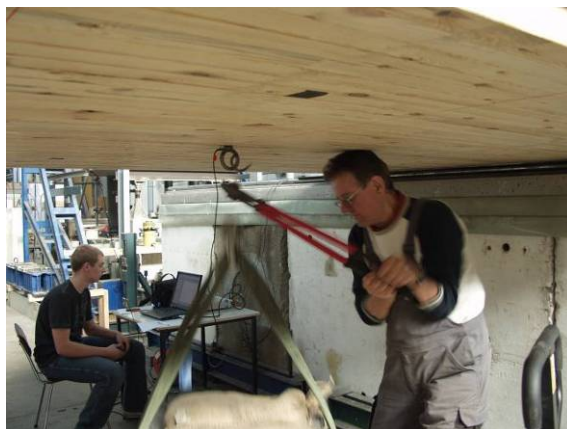
Abbildung 6-7 Anregung durch Auslenkung mit ausgeklinkter Masse
