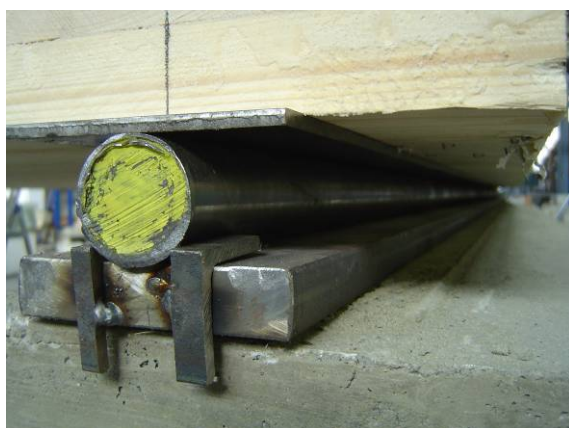
Abbildung 6-16 Großer Deckenversuchsstand, Auflagerdetail feste Rolle
