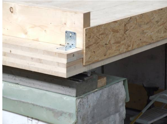
Abbildung 6-25 Großer Deckenversuchsstand, Randschalung für Fußbodenaufbauten, Detail
