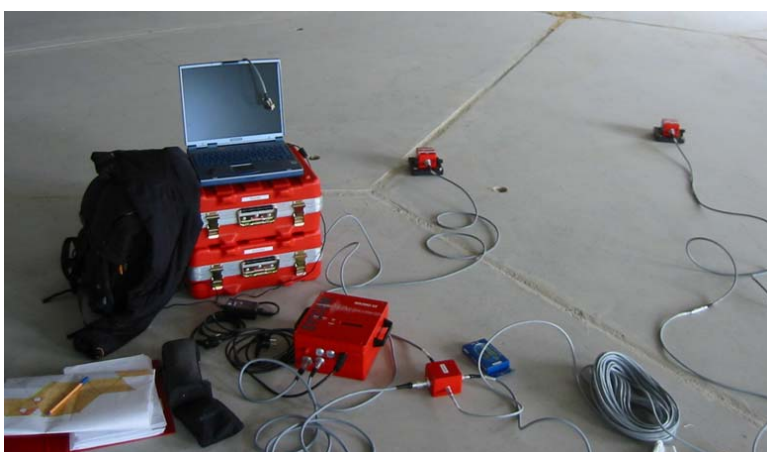
Abbildung 5-1 Die verwendete Messausrüstung: Beschleunigungsaufnehmer, Recorder und Laptop.
