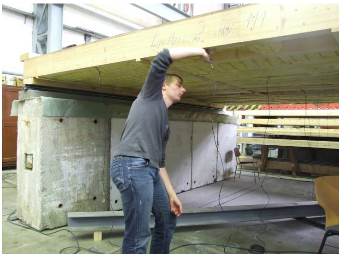
Abbildung 8.14: Anregung von unten durch Faustschlag
