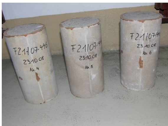
Abbildung 6-42 Anhydrit- Estrich- Zylinder, d = 150 \text{ mm}
