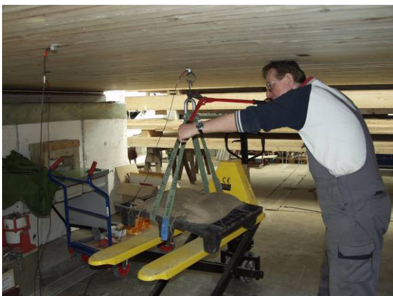
Abbildung 6-6 Anregung durch Auslenkung mit Masse
