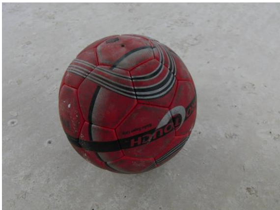
Abbildung 6-4 Anregung durch Ball
