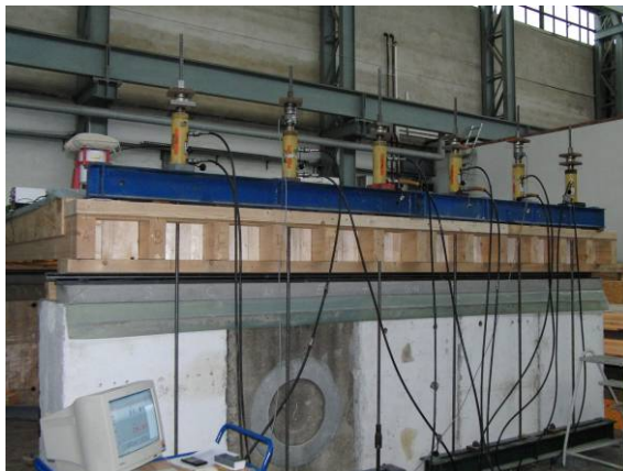
Abbildung 6-20 Großer Deckenversuchsstand, Randeinspannung
