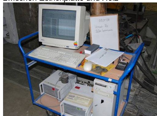
Abbildung 6-35 Messbasis mit DMC plus Messkraftverstärker
