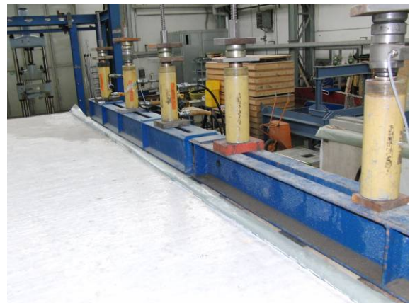
Abbildung 6-21 Großer Deckenversuchsstand, Randeinspannung von oben
