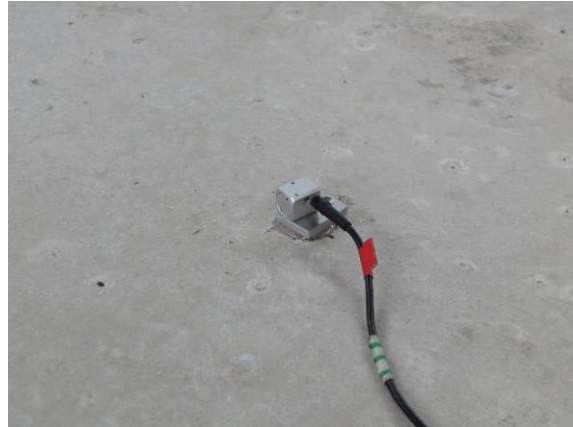
Abbildung 6-3 Beschleunigungsaufnehmer auf Nassestrich
