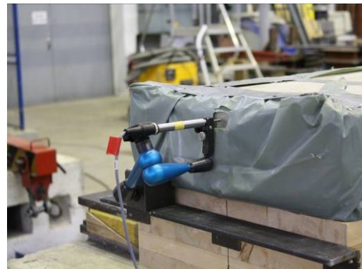
Abbildung 6-33 Wegaufnehmer misst Relativverschiebung zwischen Estrichplatte und Holz
