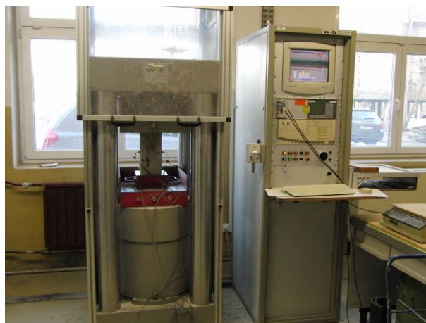
Abbildung 1-3 E-Modulbestimmung für Estrich, MFPA Leipzig
