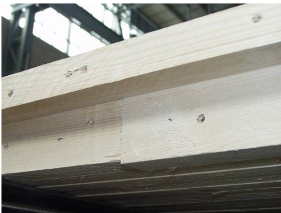
Abbildung 6-10 Brettstapelelement mit stumpfen Stößen der Lamellen, BS-D im Versuchsstand
