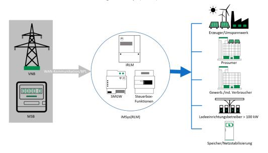
Das iMSys(RLM) aus intelligenter Zählung, SMGW und Steuerboxfunktion als zentrale Schnittstelle.
